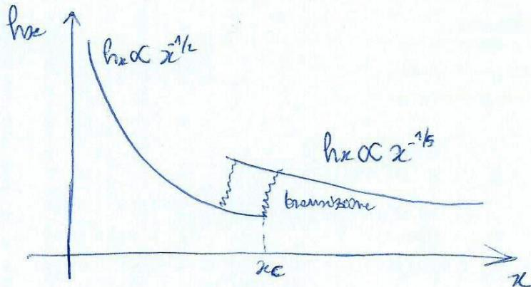
Nel laminare i coefficienti di scambio termico sono inferiori a quelli di regime turbolento.
