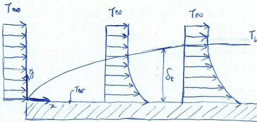
Anche qui è presente lo stesso limite, quello in cui il gradiente di temperatura si esaurisce per il 99% sul bordo  $T_b = 0,99 T_\infty$ .
