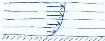
Da un certo punto ( $x_c$ ) il moto laminare inizia a rompersi e viene sostituito da quello turbolento. Messo a confronto del moto nelle altre direzioni, il regime laminare sopravvive solo in uno strato di base molto sottile!
